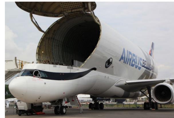
Einer von zukünftig sechs Airbus A330-700L, welche für den Transport von Flugzeugsektionen zwischen den Produktionsstätten und Fertigungsstandorten verwendet werden. Gemessen am Frachtvolumen ist der Beluga XL das größte Frachtflugzeug der Welt.
