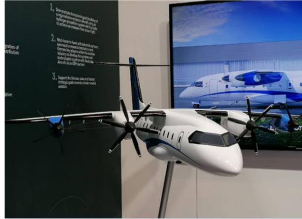
Modell eines Testflugzeug auf Basis einer Dornier 328. Die äußeren Triebwerke sollen elektrisch durch Brennstoffzellen angetrieben werden.
