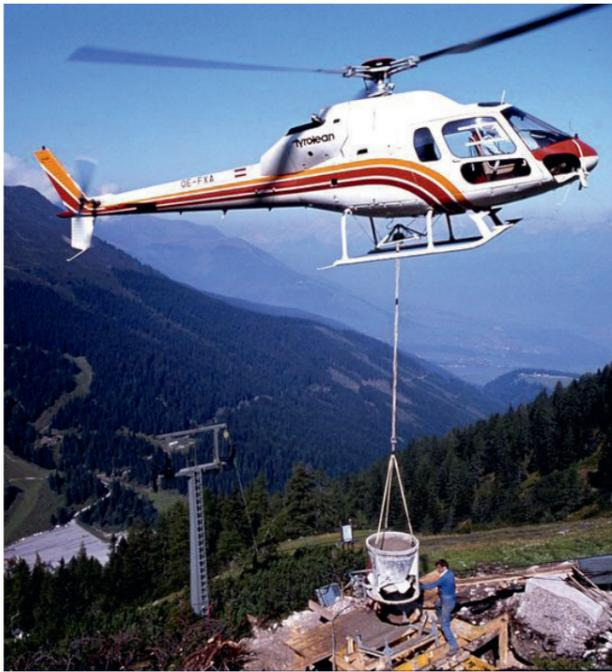
Der Tyrolean Airways-Hubschrauber der Type Aérospatiale AS 355F-1 „Twin Ecureuil“ mit der Registrierung OE-FXA im Einsatz für Bauarbeiten im Gebirge.
