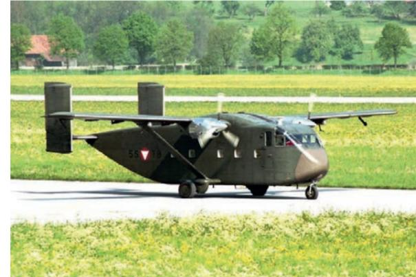
Der Schulterdecker (Short SC-7 „Skyvan“ SRS 3M - 5S-TB) weist einen quadratischen Rumpffquerschnitt mit Heckrampe und große Tragflächen auf.
