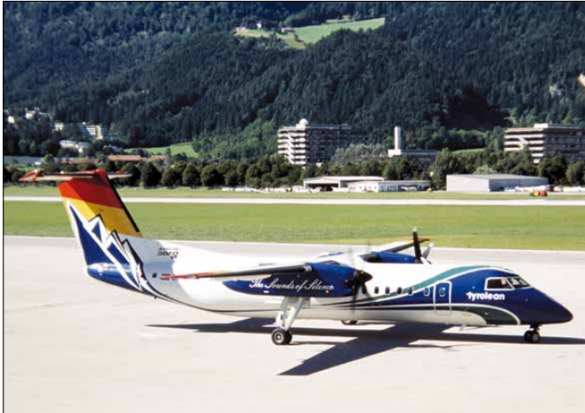
Die erste Dash 8-300Q (Q = aktives Lärm- und Vibrationsminderungssystem) fiel ab 1997 mit der Sonderlackierung „The Sounds of Silence“ auf. Foto: Gerhard Hofer, Leiblfing
